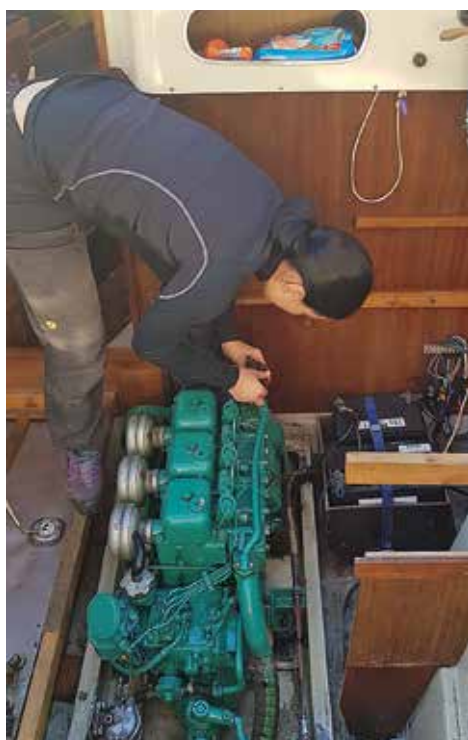
Frida meckar med motorn som är en VolvoPenta Marindiesel MD3B.
